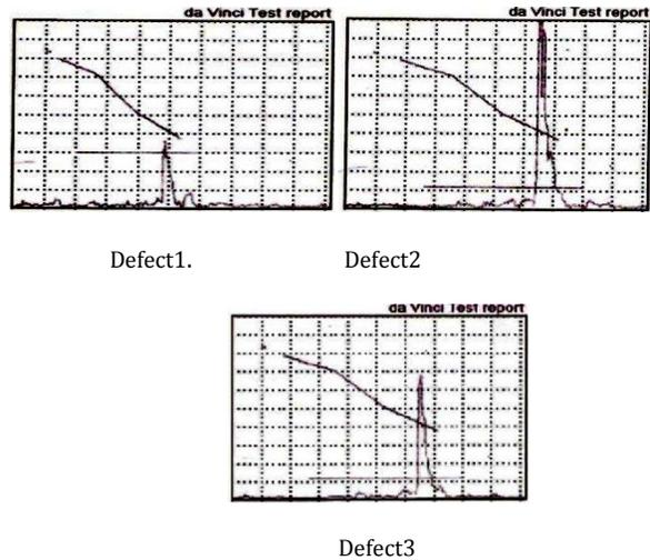
Fig1: Ultrasonic Defectogram of welded HE15 material Defect1: SD=19mm, BP=25mm, Depth (d) =2mm, Defect2: SD=25mm, BP=22mm, Depth (d) =4mm, Defect3: SD=22mm, BP=23mm, Depth (d) =3.5mm
